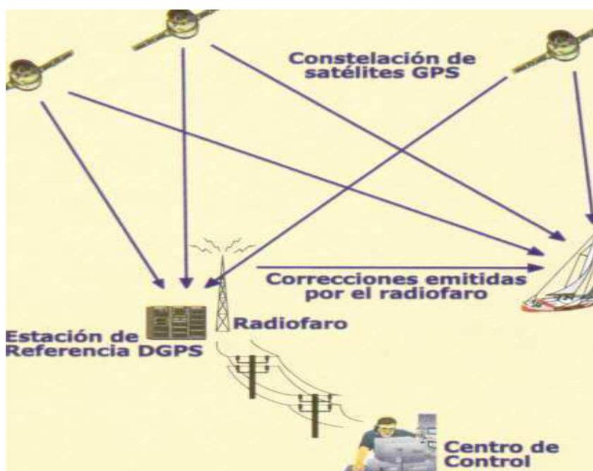
Esquema de funcionamiento de DGPS
