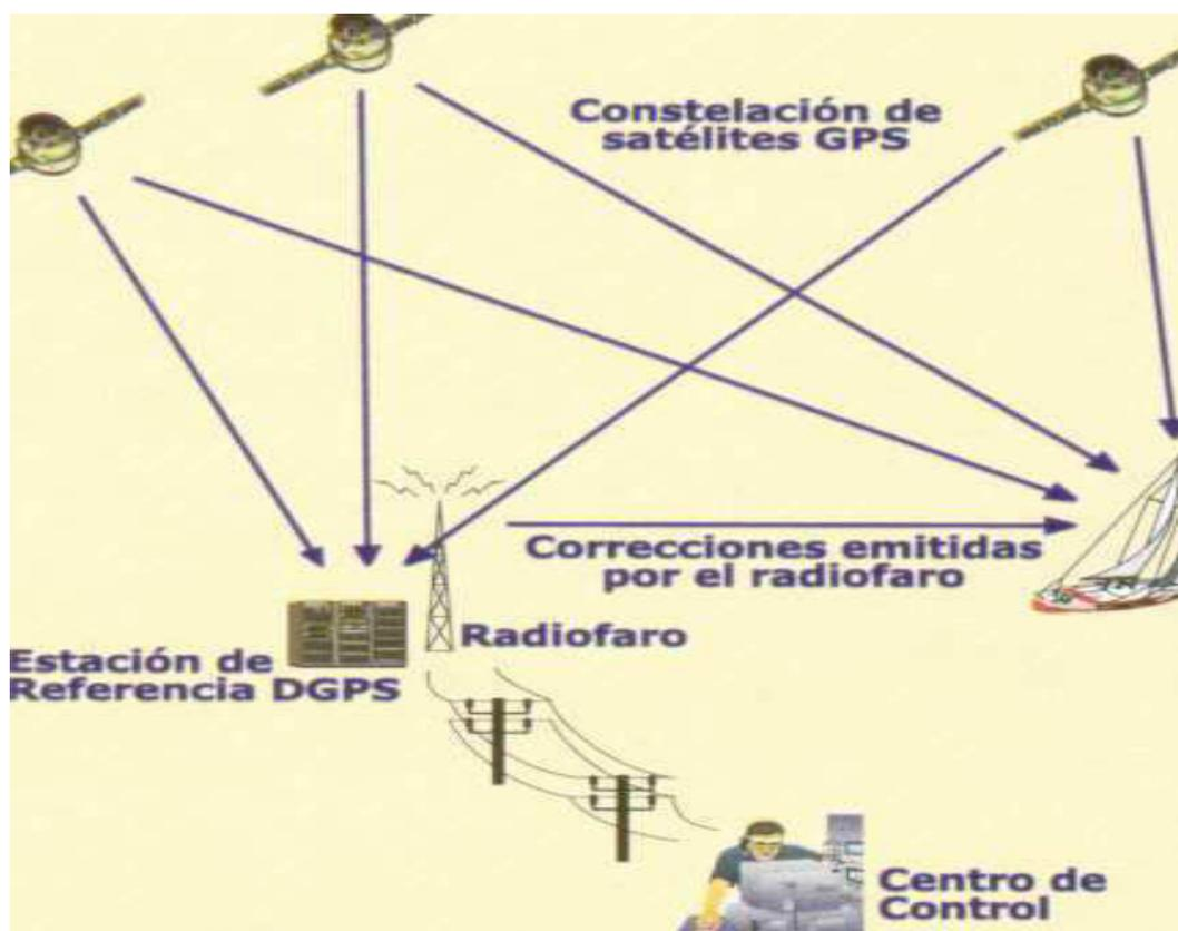
Esquema de funcionamiento de DGPS
