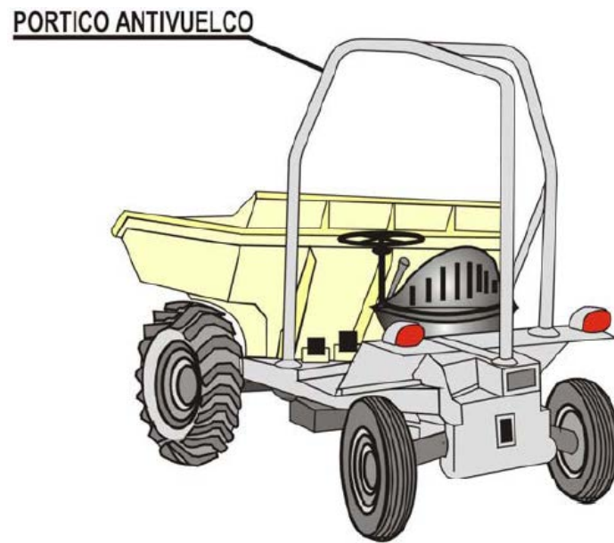
Pórtico antivuelco en dúmper y carretilla.
