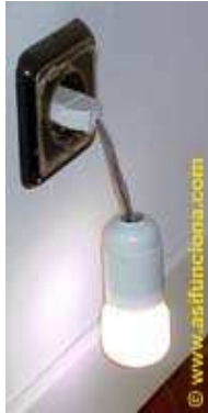
Izquierda: circuito eléctrico simple compuesto por una bombilla incandescente conectada a una fuente de FEM doméstica.
