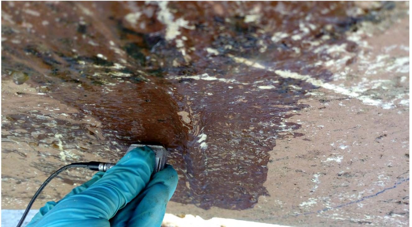
*Boya 6. Comprobación de la unión soldada en la zona abollada mediante ultrasonidos*
