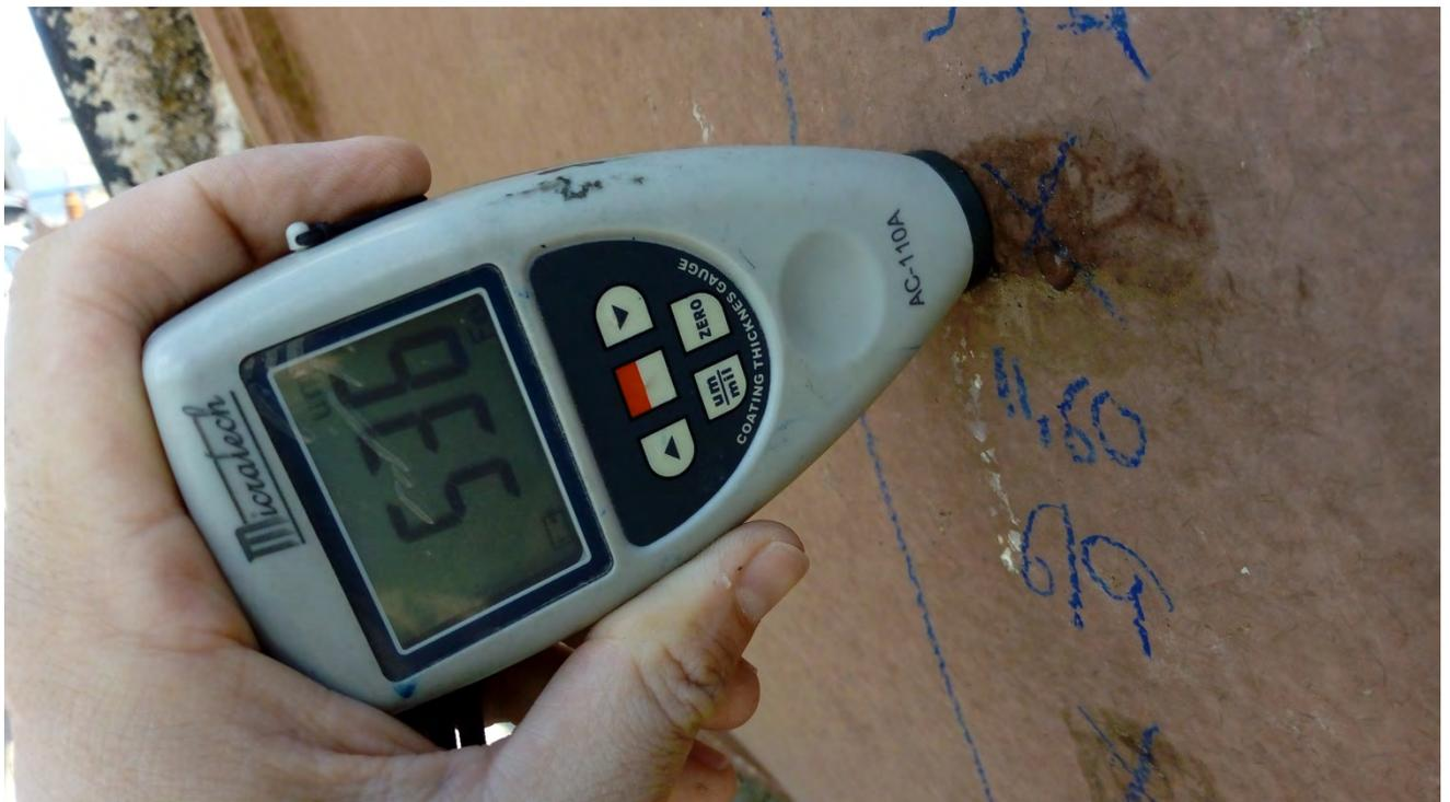
*Medición del espesor del recubrimiento en casco superior de boya 6.*
