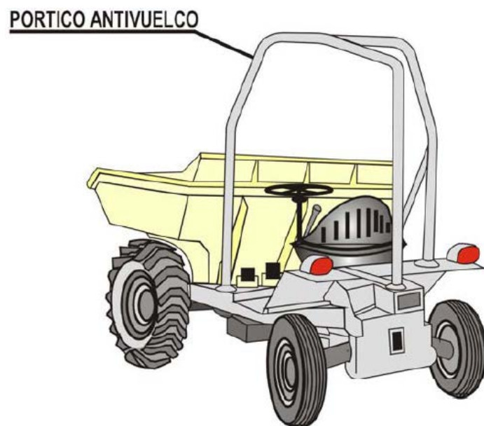
Pórtico antivuelco en dúmper y carretilla.
