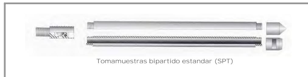
Este tipo de ensayo se realiza en el interior del sondeo y consiste en determinar el número de golpes necesarios para introducir en el terreno una puntaza de 60cm de longitud, en cuatro intervalos sucesivos de 15 cm cada uno.
