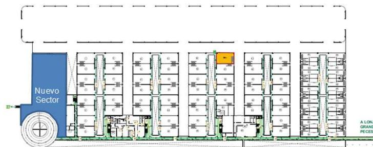
Nota 1: Se propone sectorizar la conexión existente en la primera planta entre el edificio de la Nueva Lonja de Altura y el de la Lonja de Grandes Peces y Bajura.
