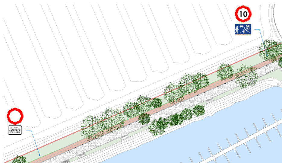
Imagen 19 Ubicación de la nueva señalización para el tráfico rodado.
