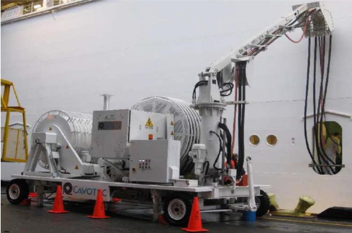
Figura 12. Ejemplo de grúa móvil para la gestión de cables. Fuente: Cavotec.
