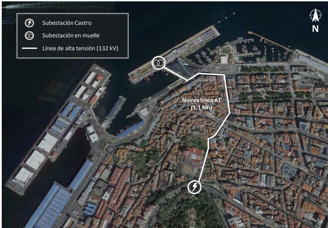
Figura 14. Esquema orientativo de la acometida a la red eléctrica.
