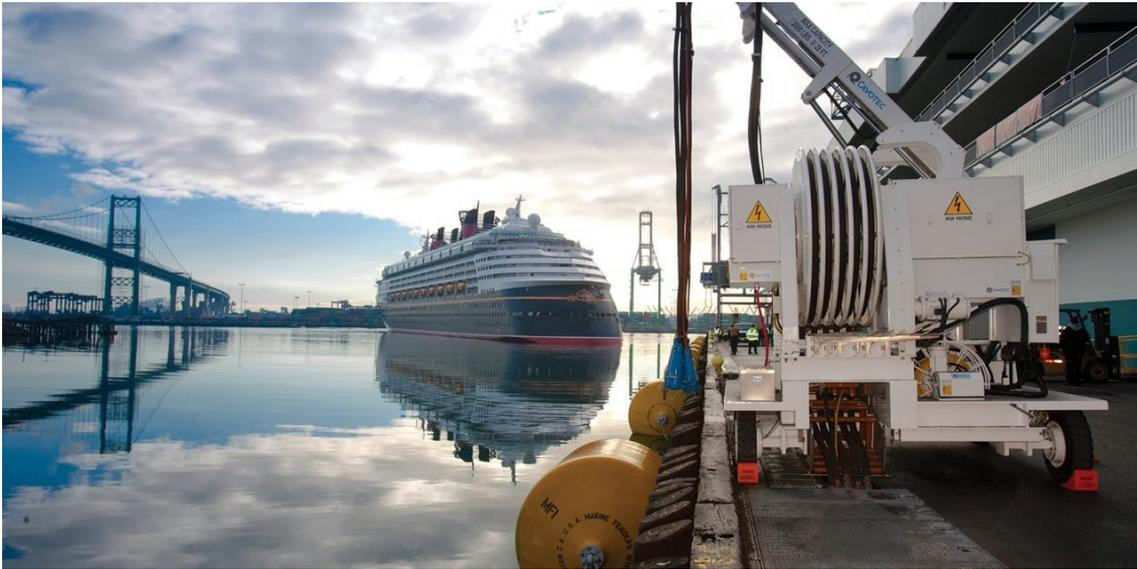
Figura 25. Ejemplo de grúa móvil para la gestión de cables. Fuente: Cavotec.
