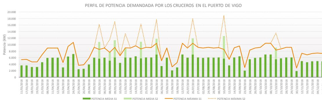
Figura 8. Detalle de la demanda horaria media y máxima de los cruceros atracados en el Muelle de Trasatlánticos en 2018 (ver Anexo V).
