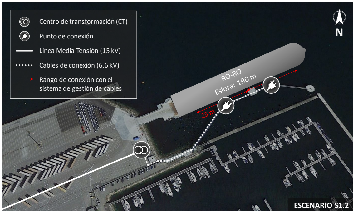
Figura 18. Esquema de la configuración del sistema OPS en la Terminal de Ro-Ro, Escenario S1.2.
