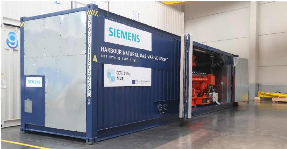
Figura 24. Ejemplo de contenedor para albergar los equipos de generación eléctrica. Fuente: Suardiaz /18/.
