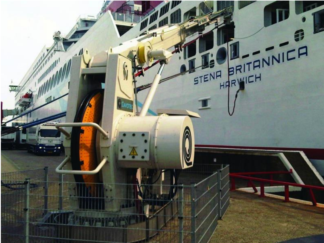
Figura 11. Sistema de gestión de cables AMPTelescopic. Fuente: Cavotec.
