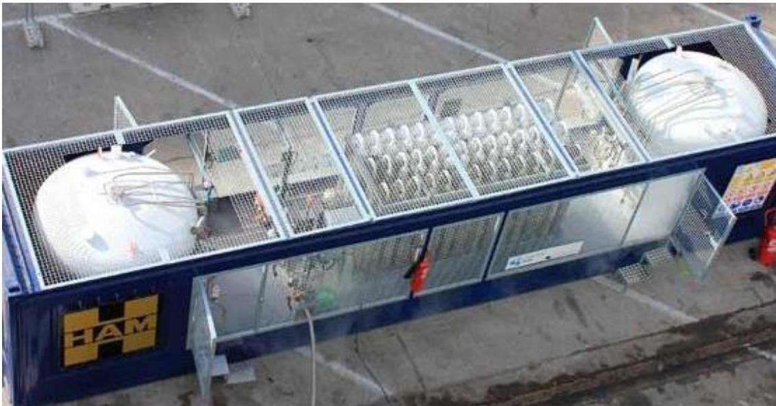
Figura 23. Ejemplo de contenedor para albergar el sistema de almacenamiento de GNL y la unidad de regasificación. Fuente: HAM.
