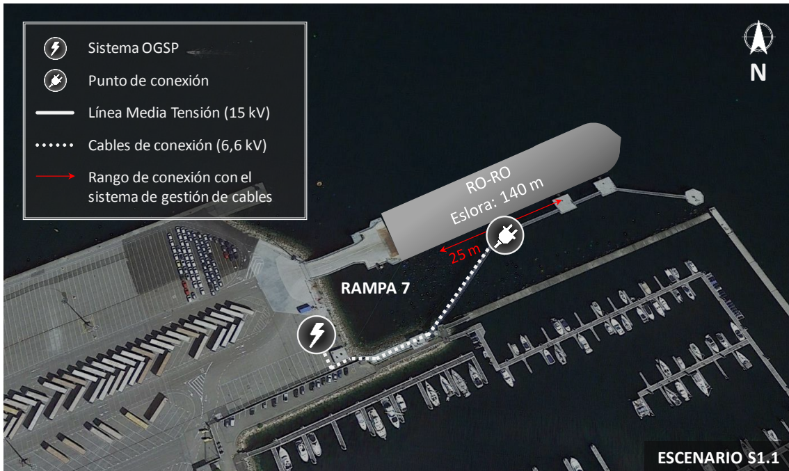
Figura 25. Esquema de la configuración del sistema OGSP en la Terminal de Ro-Ro, Escenario S1.1.
