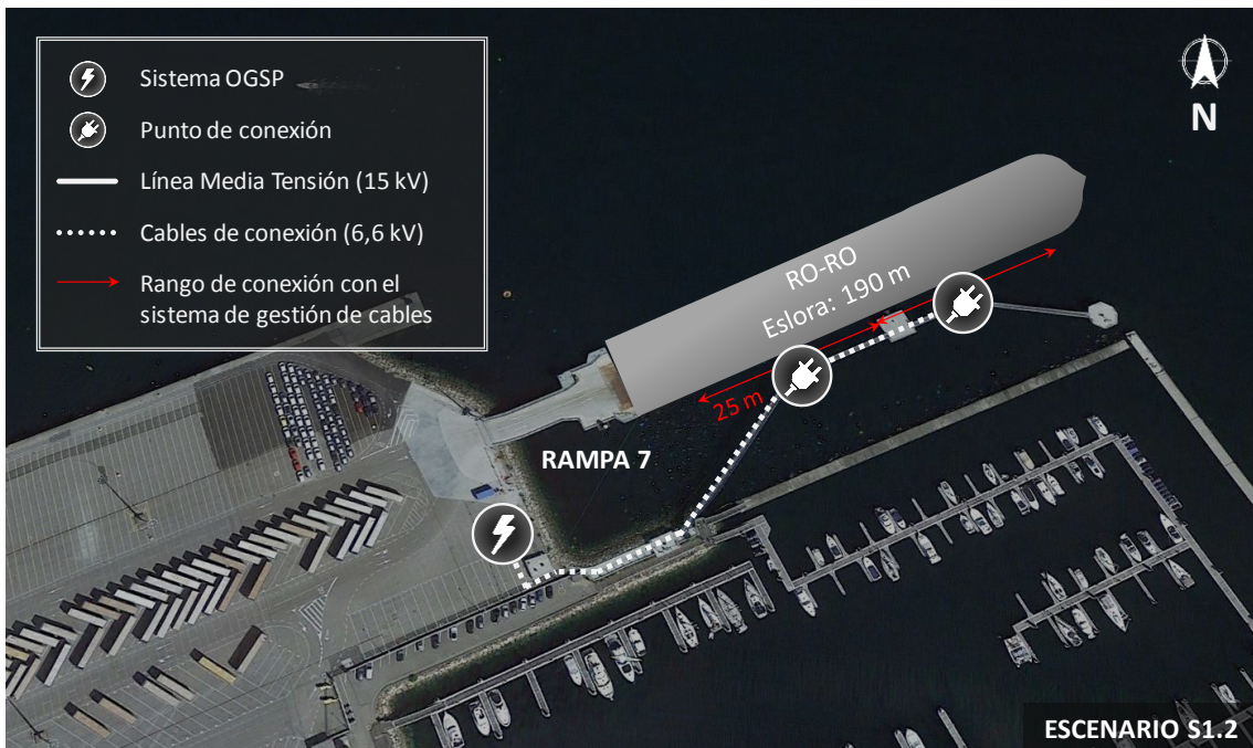
Figura 26. Esquema de la configuración del sistema OGSP en la Terminal de Ro-Ro, Escenario S1.2.
