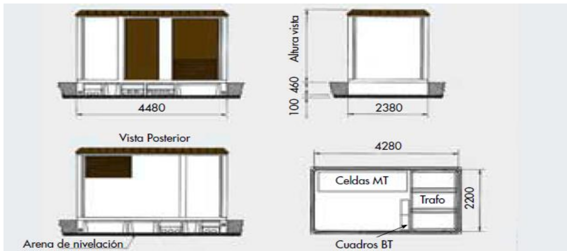
Figura 16. Edificación para alojar los componentes eléctricos necesarios para el sistema OPS. Fuente: Ormazábal.
